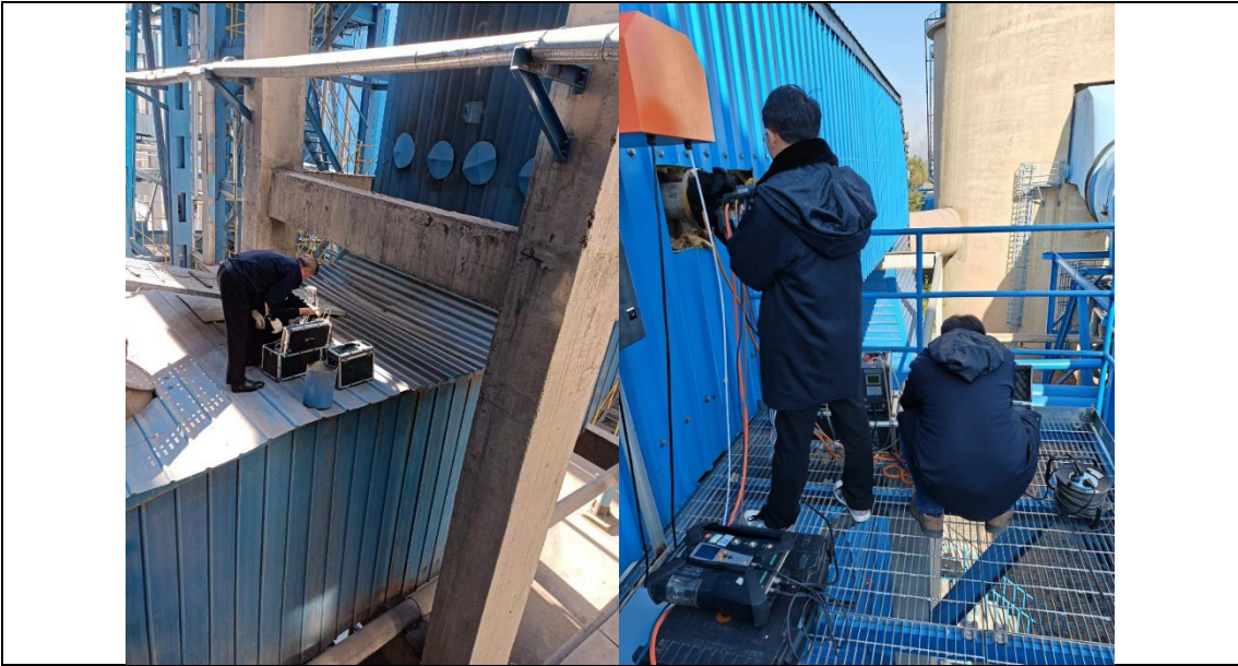
图 9-1 废气现场监测图
